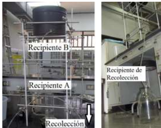
Figura 1. Diagrama del montaje experimental a escala de laboratorio para el tratamiento de sustratos contaminados asistido por flujo gravitacional y rebose. Izquierda: detalle de recipientes de alimentación y reacción. Derecha, sistema de recolección de efluentes.
