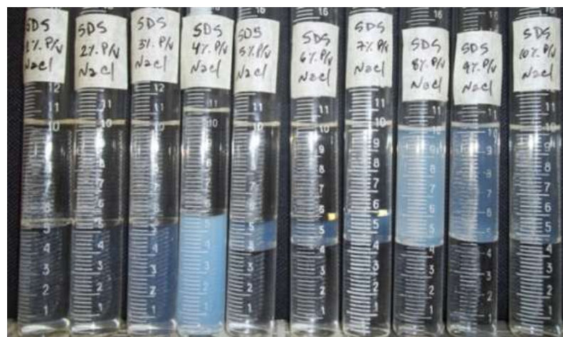
Figura 2. Evaluación de la respuesta de fase (Winsor) mediante barrido de salinidad (NaCl) para el sistema SDS/Kerosén/Agua.
